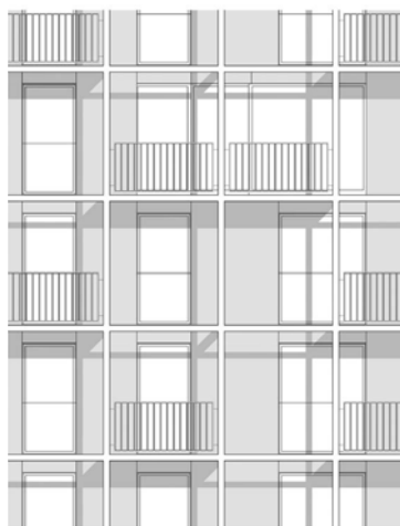
Détail en élévation de la façade « grille » et panneaux
